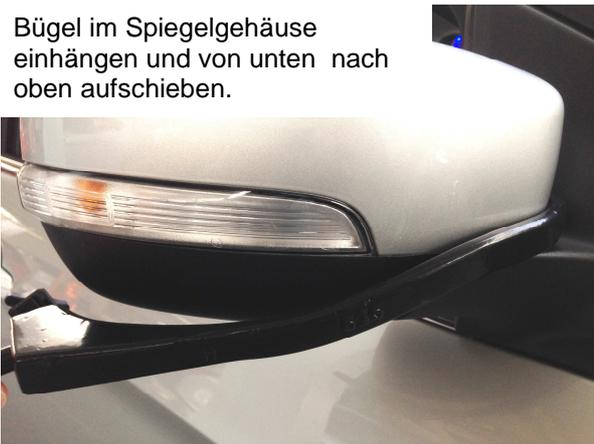
2. Bügel mit leichtem Druck bis unter den Blinker schieben.
