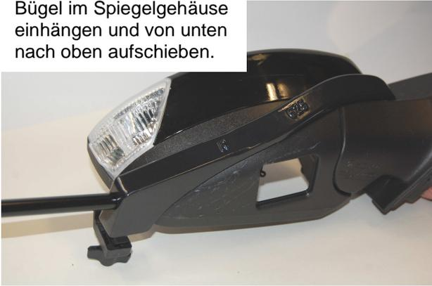
2. Bügel mit leichtem Druck bis unter den Blinker schieben.
